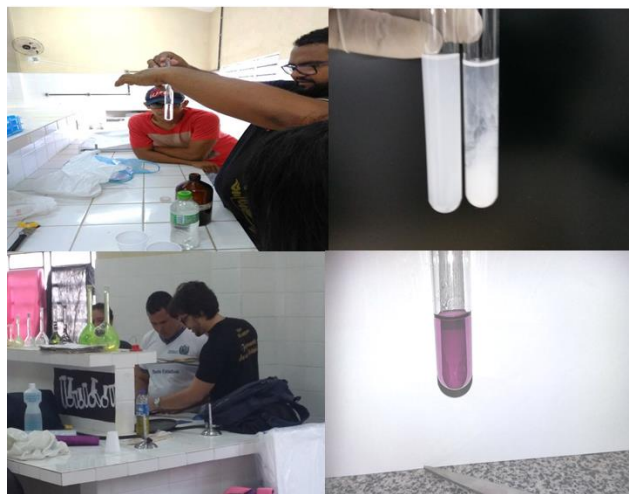
Figura 2. Atividade Experimental Teste Qualitativo de Dureza da água
