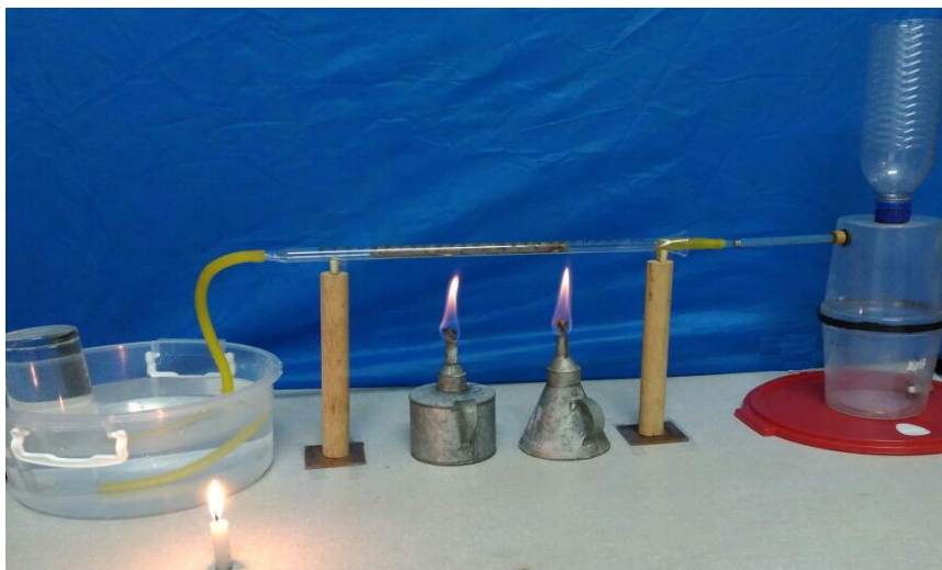
Figura 3 – Equipamento para separação do ar atmosférico
