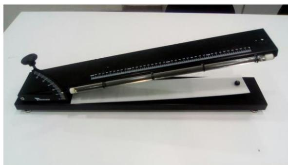
Figura 2. Equipamento utilizado como corpo básico para os experimentos de MRU, MRUV, e decomposição de forças.
