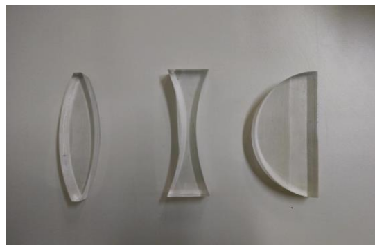
Figura 1: Lentes esféricas: (a) biconvexa; (b) bicôncava e (c) plano convexa.
