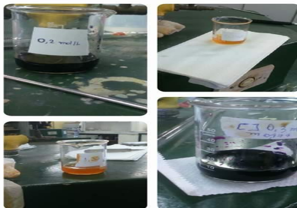
Figura 2: Corrosão de fios de cobre em soluções oxidantes de diferentes concentrações.
