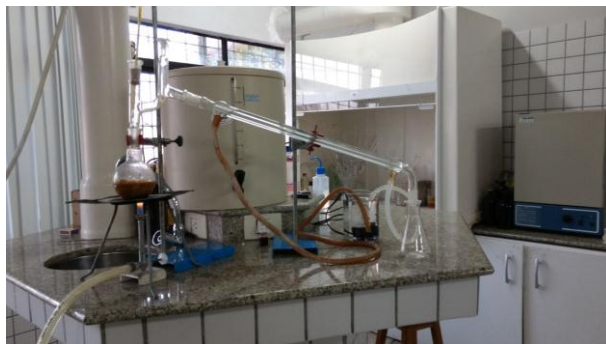
Figura 3- Destilação mosto fermentado da algaroba
