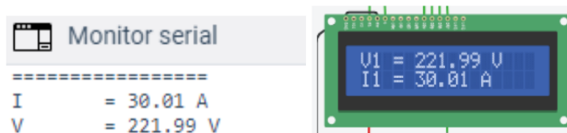
Figura 3. Valores obtidos no monitor serial (à esquerda) e LCD (à direita) do protótipo com referência simulando uma rede de 30,01 A e 221,99 V.
