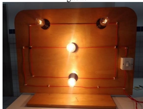
Figura 8: Associação com lâmpadas ligadas
