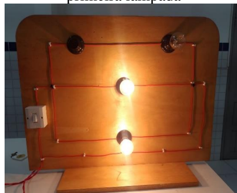
Figura 10: Associação com retirada da primeira lâmpada
