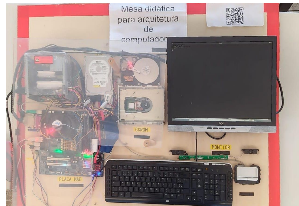
Figura 2 - Mesa de testes e aprendizagem de componentes de hardware com seus componentes ligados e identificados em Braille
