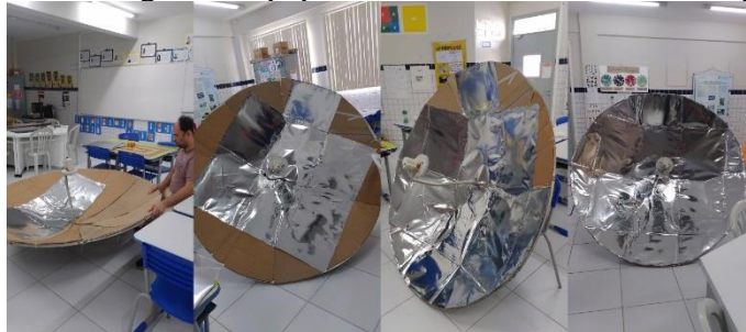
Figura 5: Colagem dos papeis laminados sobre a base de papelão
