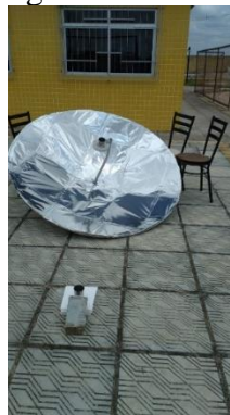
Figura 7: Forno solar com amostra de água e amostra de água no solo sobre uma base.
