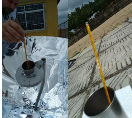
Figura 9: Medição de temperatura no primeiro teste
