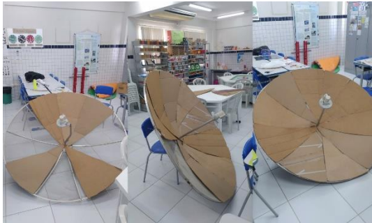
Figura 4: Fixação dos papelões na base da antena
