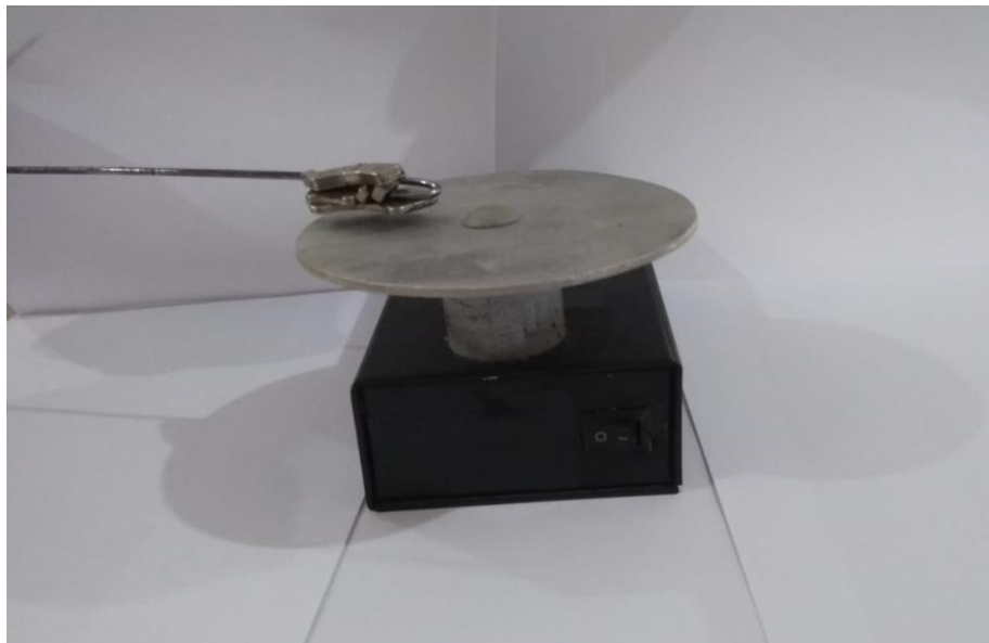
Figura 01 – Experimento demonstrativo da aplicação do freio magnético
