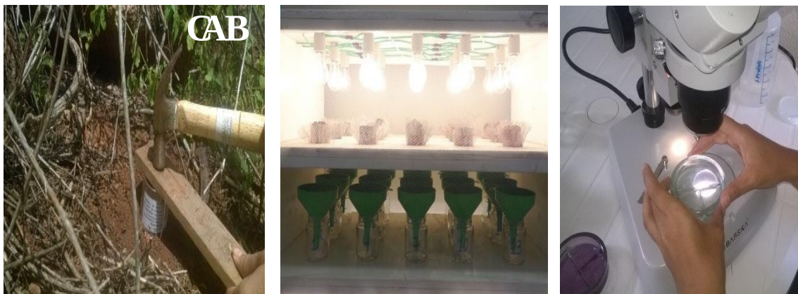
Figura 1. Introdução dos anéis no solo (A), Anéis inseridos na bateria de extratores Berlese-Tullgren modificada (B), Identificação dos organismos edáficos (C).
