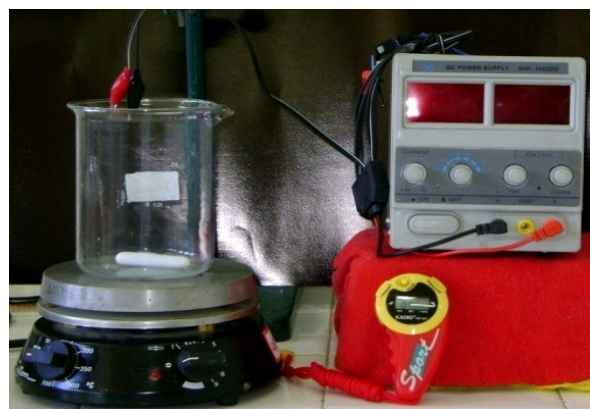
Figura 1: Sistema experimental para tratamento por eletrofloculação.
