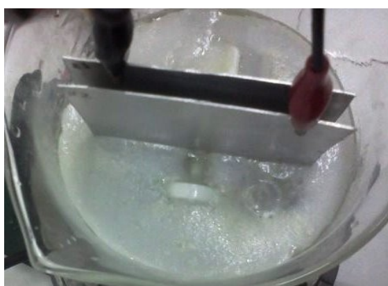
Figura 3: Fotografia da visão superior do reator contendo material flotado.
