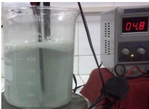
Figura 2 - Fotografia do reator eletroquímico em funcionamento.
