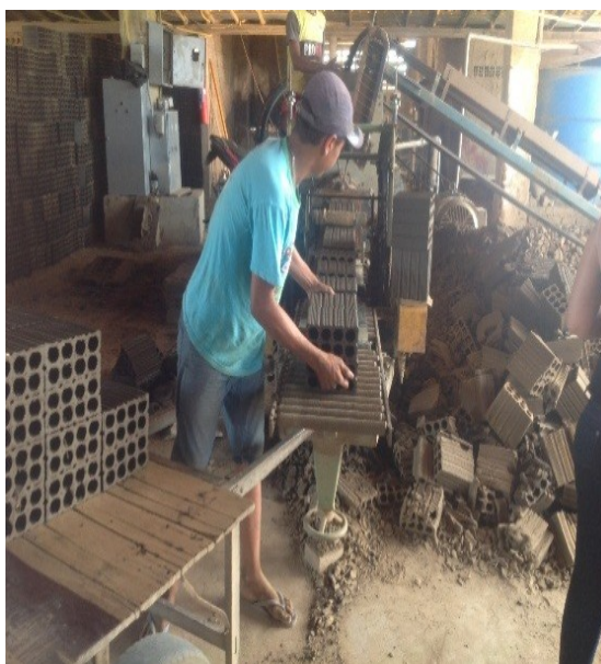
Figura 01 – Trabalhador sem Uso de EPI's
