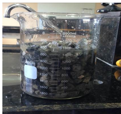
Figura 2. Meio filtrante – Brita
