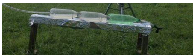
Figura 2. Canal de Desinfecção (vista lateral) Fonte: Autor, 2015.
