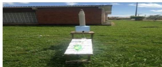
Figura 4. Imagem lateral do sistema filtro lento-canal de desinfecção.
