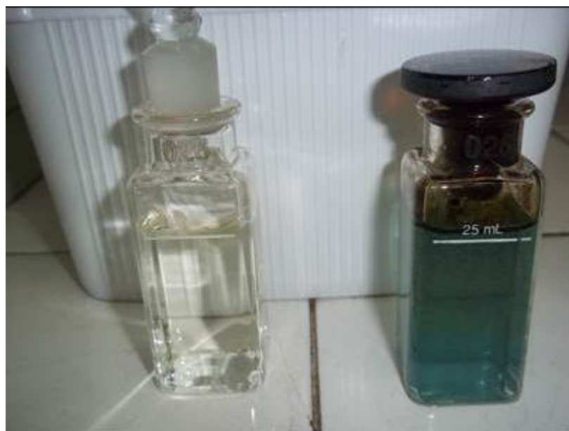
Figura 2 – Coloração azulada representando grande concentração de enxofre na amostra.
