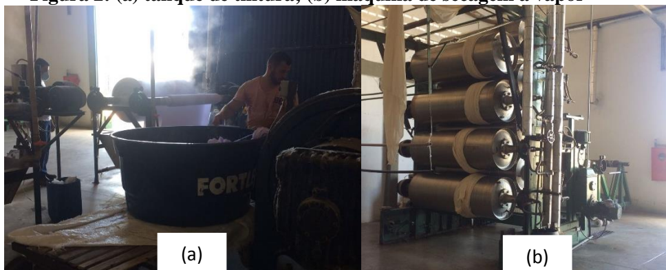
Figura 2: (a) tanque de tintura; (b) máquina de secagem a vapor
