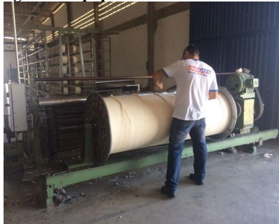
Figura 2: Equipamento de adesão dos fios
