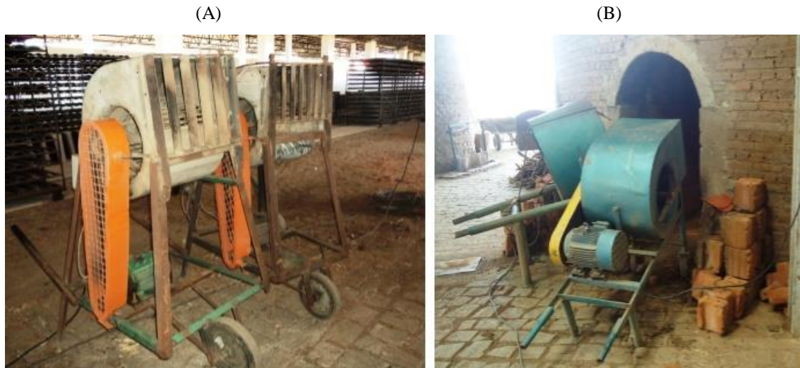
Figura 11. A) Ventoinha utilizada na cerâmica Bela Vista durante a fase de resfriamento dos fornos; B) Modo de utilização da ventoinha
