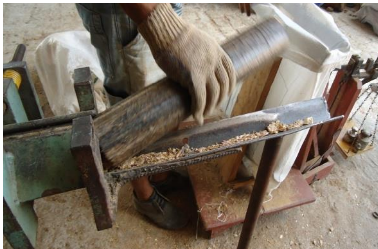
Figura 6 - Fase final da produção do briquete
