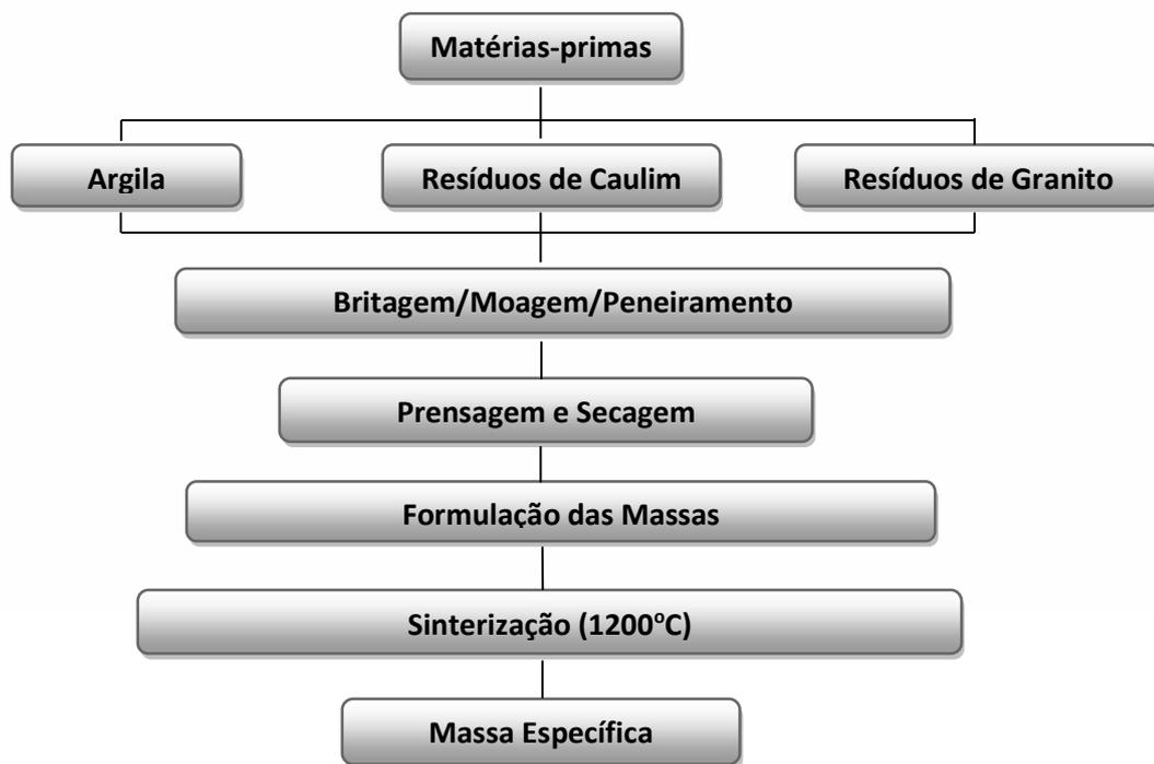
**Figura 2** - Esquema do procedimento experimental.
