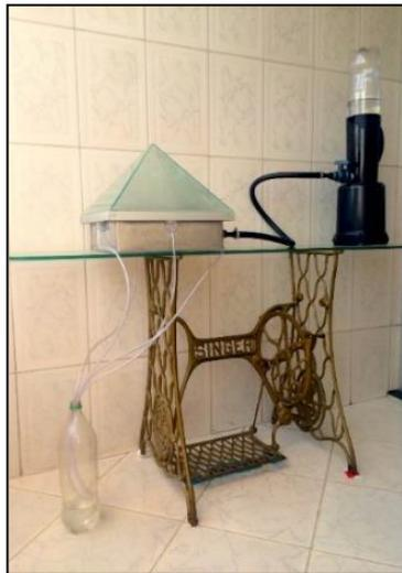
**Figura 2** – Destilador solar desenvolvido no projeto.
