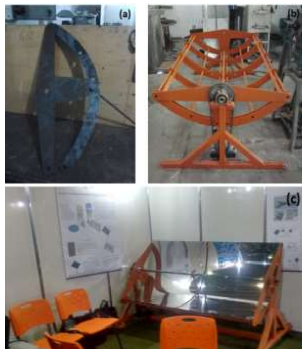
Figura 8 - Etapas da fabricação do coletor solar cilíndrico parabólico. a) Perfis obtidos com o corte a laser, b) Estrutura do coletor obtida a partir dos perfis e c) Coletor solar montado
