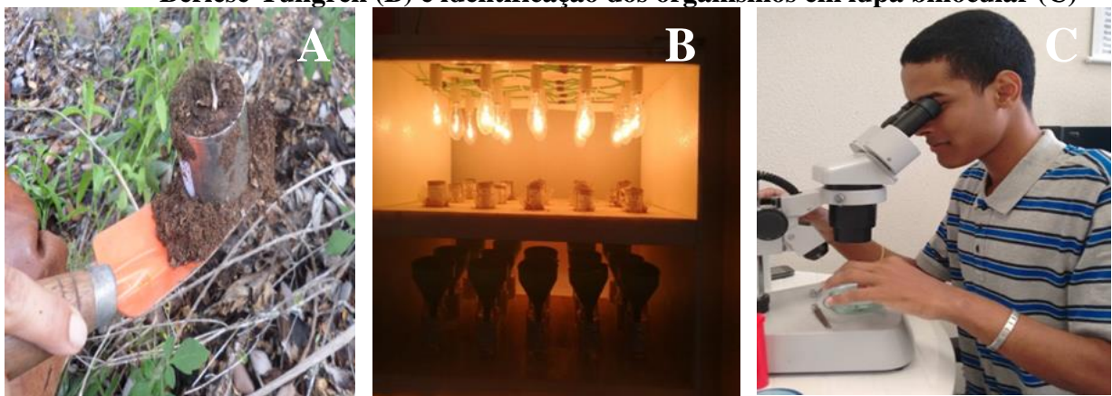
Figura 1 – Coletas de solo+serapilheira com anéis metálicos (A), bateria de extratores Berlese-Tullgren (B) e identificação dos organismos em lupa binocular (C)
