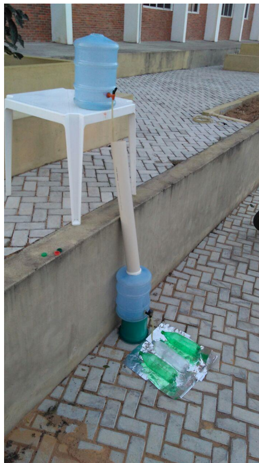
Figura 2 – Protótipo do Sistema de tratamento
