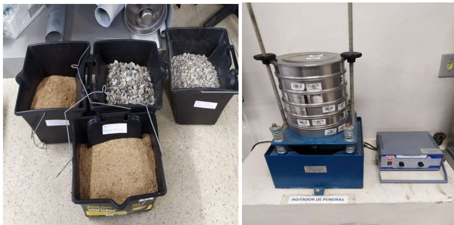
Imagem 1 e 2: Amostras de materiais coletados e ensaio de granulometria
