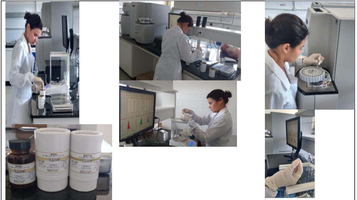
Figura 1: Determinação de Carbono e Nitrogênio total das frações e da massa total do solo. LECO modelo CHN 628S.
