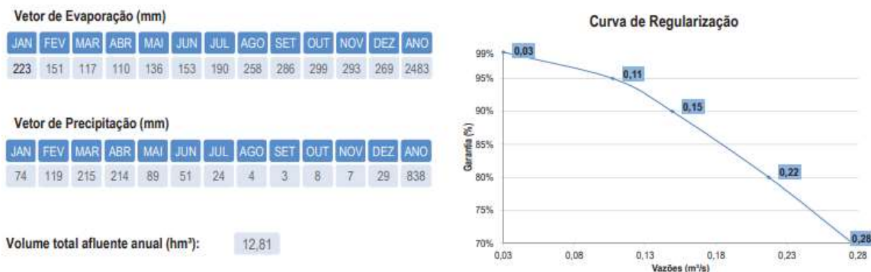
Figura 5 – Curva de Regularização e média anual de evaporação do volume do Açude Lucrécia. Fonte: ANA/SAR, 2018.
