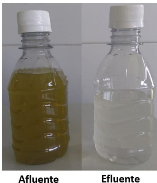
Figura 4. Comparação do efluente da lagoa de estabilização antes e depois da infiltração na coluna de solo.
