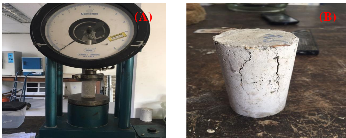
Figura 5 - (A) Prensa Hidráulica para rompimento e (B) Corpo de prova após o rompimento. Fonte: Arquivo dos autores (2019).
