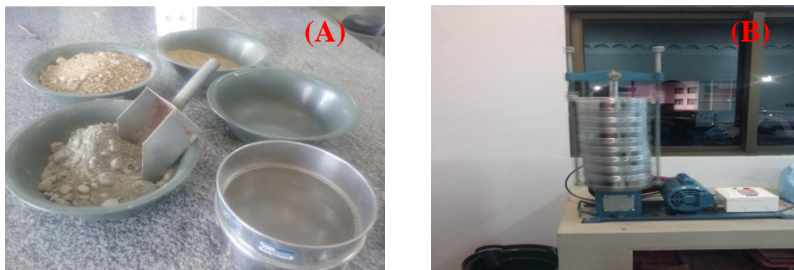
Figura 2 - (A) Material agregado e peneiras para granulometria e (B) Máquina de peneiramento. Fonte: Arquivo dos autores (2019).
