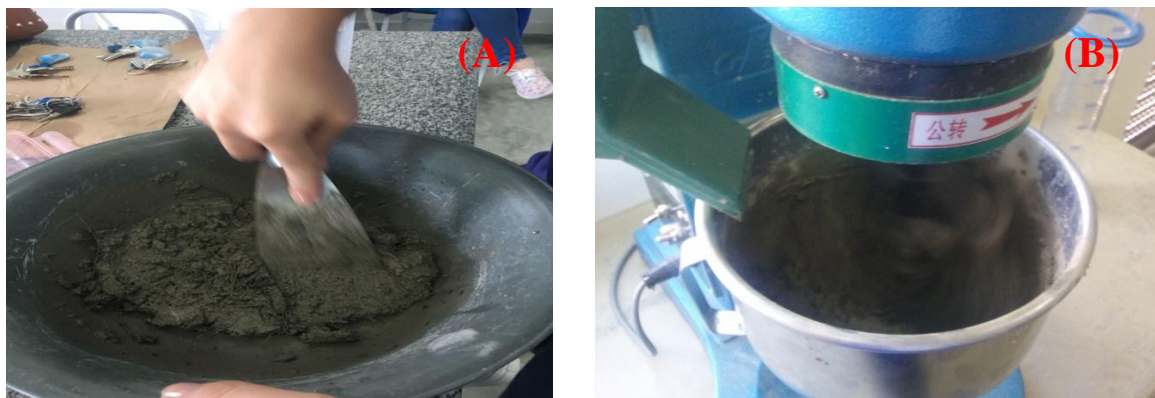
Figura 3 - (A) Mistura manual da argamassa com a fibra de coco e (B) Mistura mecânica da argamassa com Argamassadeira eletro-mecânica (Contenco - Modelo I 3010). Fonte: Arquivo dos autores (2019).
