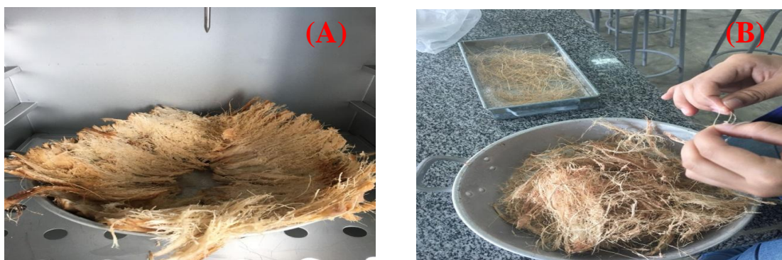
Figura 1 - (A) Secagem da fibra de coco em estufa após retirada do tanino e (B) Separação da fibra de coco seca. Fonte: Arquivo dos autores (2019).
