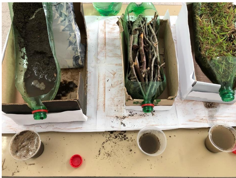
Figura 3. Representação do efeito da erosão hídrica no solo sem cobertura vegetal, com cobertura vegetal morta e com cobertura vegetal viva.
