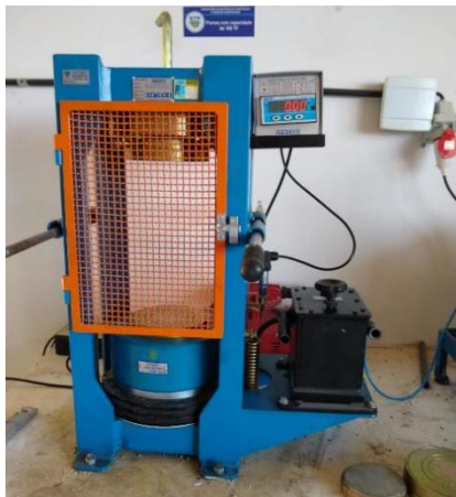
Figura 05 – Equipamento utilizado para determinação da resistência à compressão
