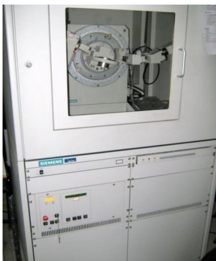
Figura 2 – Equipamento usado para as análises Difração de raios-x.
