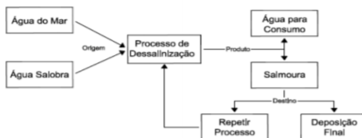
Figura 2. Esquema Geral do Processo de Dessalinização. Fonte: ARAÚJO(2013) p. 10.
