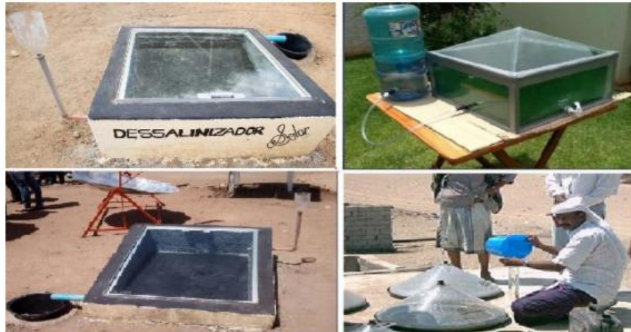
Figura 3. Dessalinização e desinfecção de águas através de dessalinizadores solar. Fonte: SILVA,(2017) p.34.
