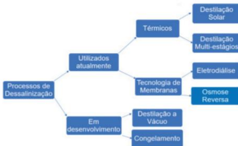
Figura 7. Processos de dessalinizadores em uso e em desenvolvimento. Fonte: BEZERRA et. al. (2019), p. 108.
