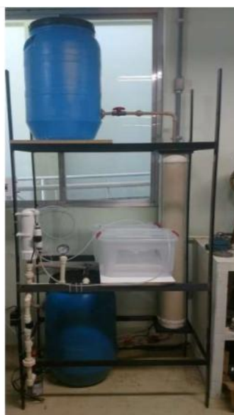
Figura 6. Fotografia do protótipo experimental do dessalinizador por Osmose Reversa. Fonte: CAETANO; ROMEU E SILVA NETO (2018) p. 376.
