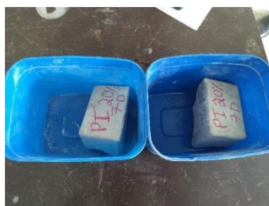
Figura 3: Amostras utilizadas no ensaio de absorção.
