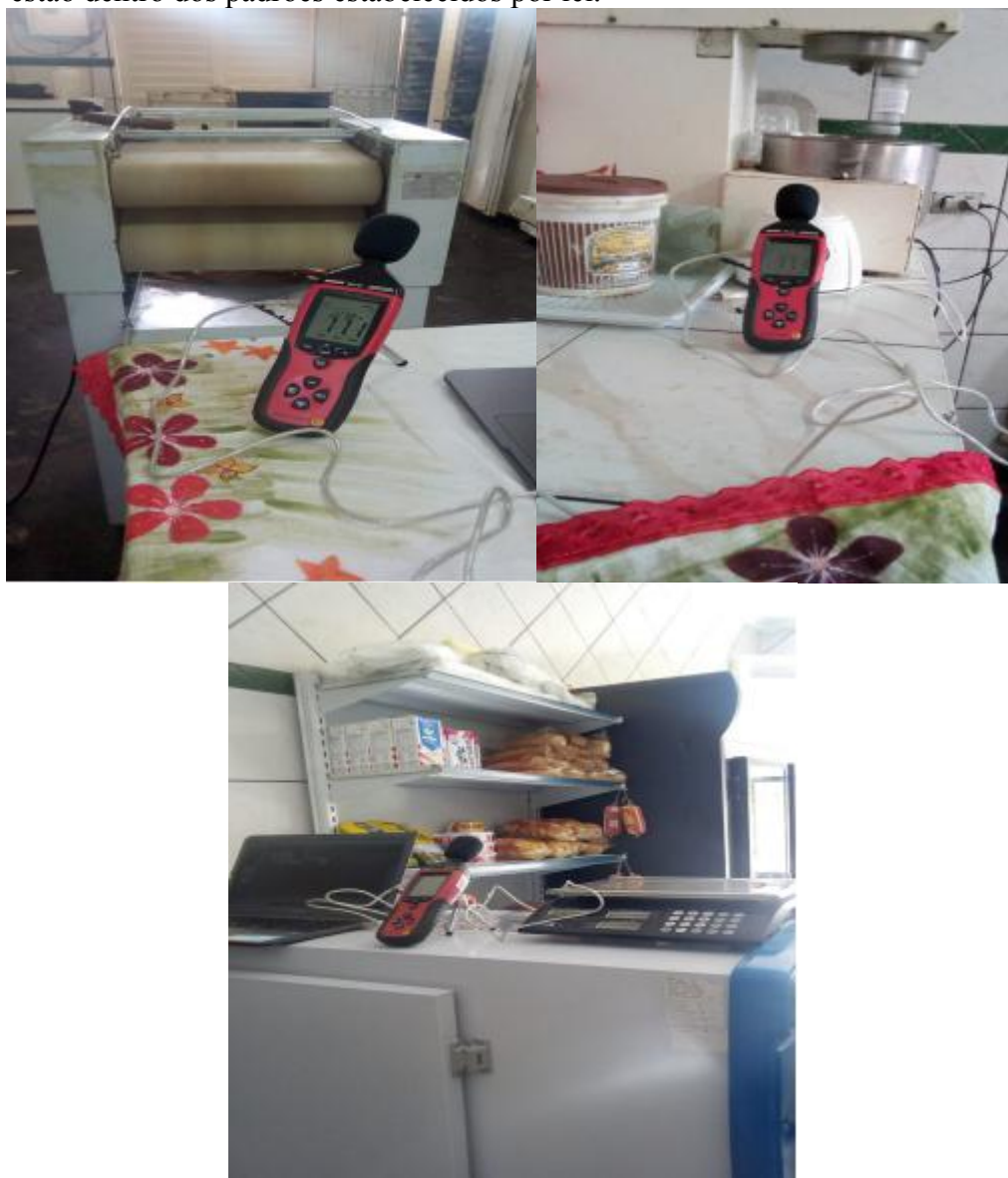
Figura 2. Medição do nível de pressão sonora na área de produção (acima) e atendimento (abaixo)
