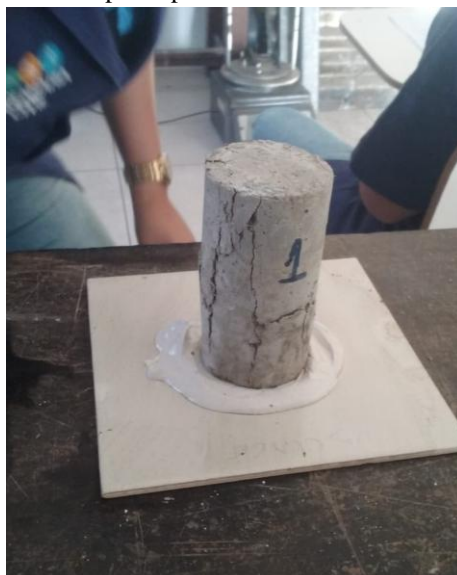
Figura 1 - Corpo de prova 1 Concreto convencional.
