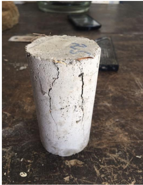
Figura 2 - Corpo de prova 2 com concreto modificado com fibra do coco a 25mm.
