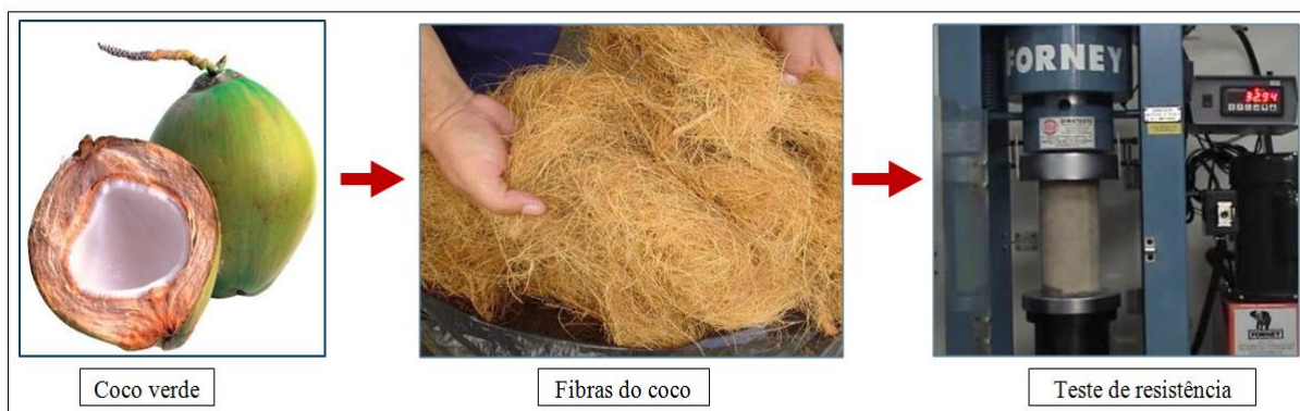
Figura 1 - Coco verde, fibras extraídas do coco e teste de resistência em concreto modificado com fibras.
