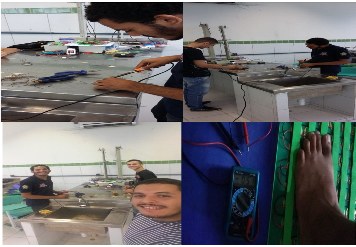
Figura 9- Montagem do Tapete de PZT (Fonte: Autores, 2018)
