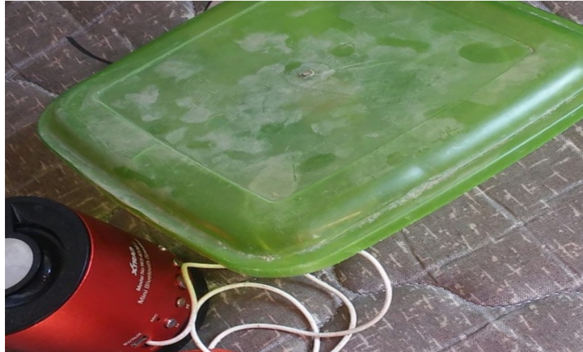
Fotografia 3: Experimento o prato de Chladni
