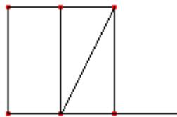
Com a ponta seca do compasso no vértice inferior esquerdo do segundo retângulo, abertura igual a medida da diagonal, traçamos um arco do vértice direito superior do retângulo ao prolongamento do lado DC do quadrado.
