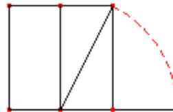
Partindo do ponto de interseção do arco com o segmento da base, traçamos o segmento EF paralelo ao lado AD. Prolongamos o lado AB do quadrado até encontrar o segmento EF para formar o retângulo;
