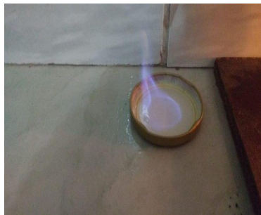
Figura 6 – Teste para verificar que o destilado inicial é composto apenas por álcool – Fonte: Os autores
