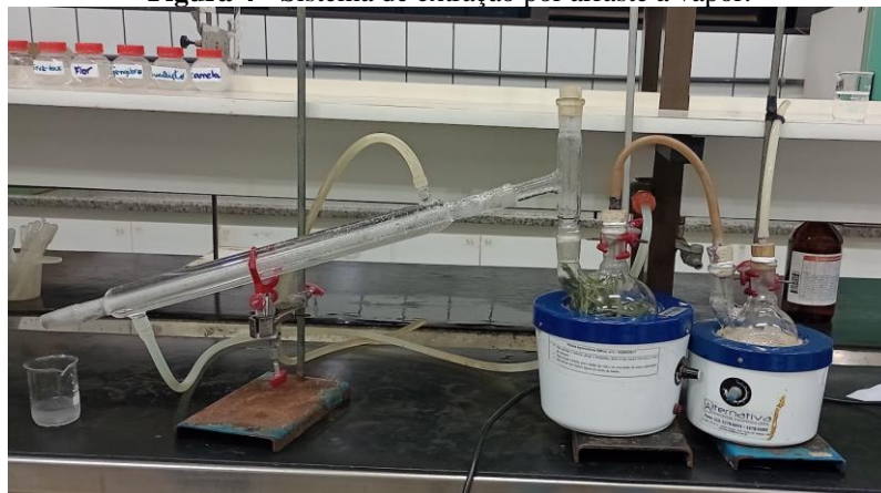
Figura 4 - Sistema de extração por arraste a vapor.
