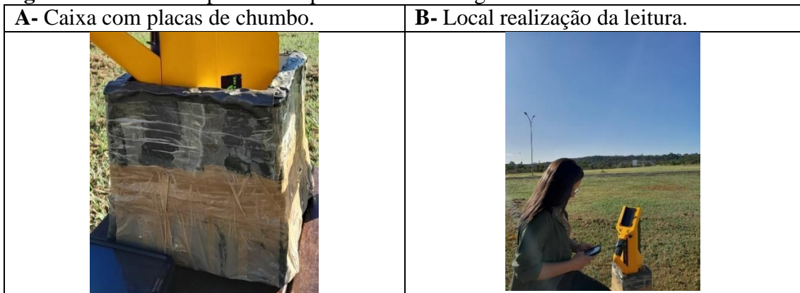
Figura 4- Leitura dos pontos dos pontos de amostragem.
