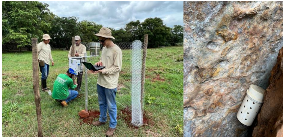
Figura 2A e 2B Instalação do pluviógrafo e termo-higrômetro
