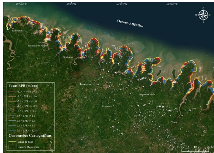
Figura 4. Cartografia das Taxas do Ponto Final (EPR) obtidas a partir do DSAS v5. Fonte: Autores (2024).
