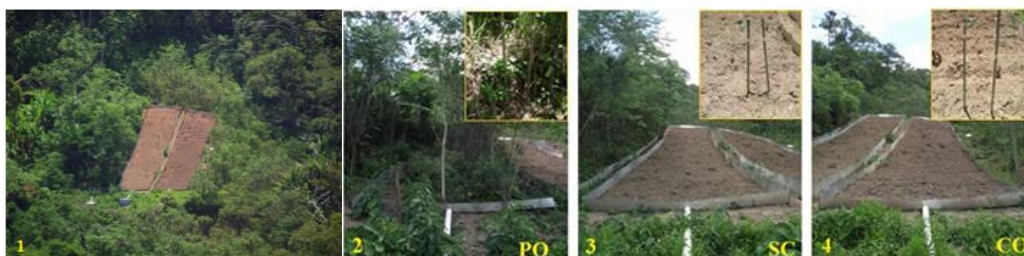
Figura 2: Imagens das parcelas de erosão, com Sistemas de Pousio (PO), Sistema de Plantio (PL) e Sem cobertura (SC).
