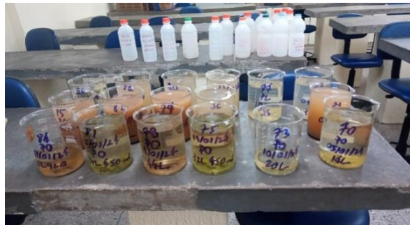
Figura 3: Amostras colocadas dentro de beckers de 1L para avaliação da perda de solo.
