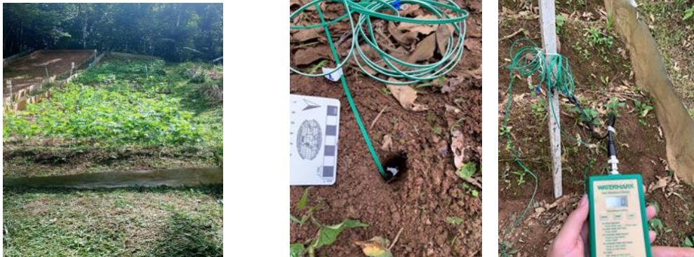
Figura 4 e 5 : Parcela com sistema de coivara com plantio de couve – flor (PL); Instalação dos tensiômetros nas respectivas parcelas de erosão.
