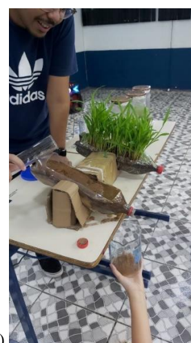
Figura 3 - Experimento hidro erosivo comparativo entre solo sem cobertura vegetal e coberto por vegetação aplicado na escola.
