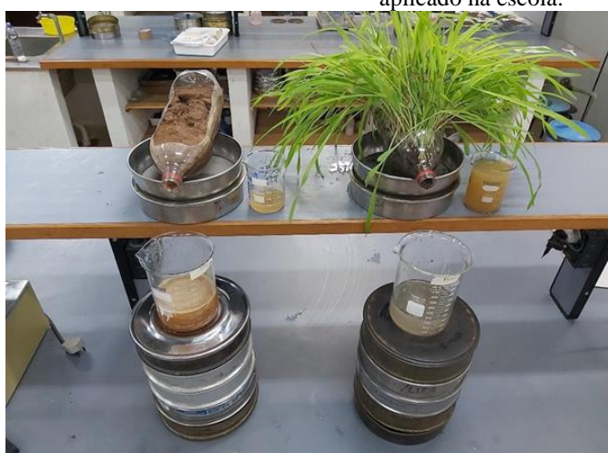
Figura 3 - Experimento hidro erosivo comparativo entre solo sem cobertura vegetal e coberto por vegetação aplicado na escola.
