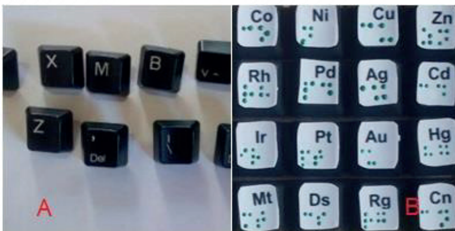
Figura 4: Seleção e adaptação dos botões/teclas usada na construção da TPI. (A) Teclas selecionadas para o uso. (B) Teclas adaptadas e finalizadas para o uso
