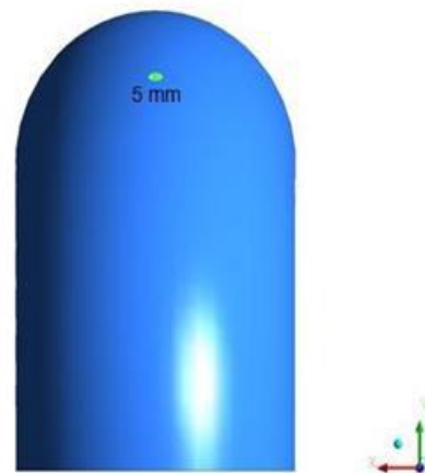
Figura 2: Curvatura com vazamento
