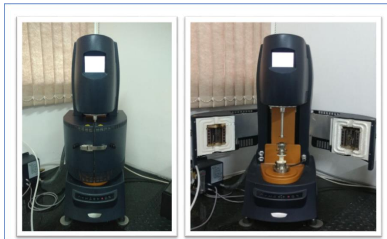
Figura 3: Reômetro de cisalhamento dinâmico
