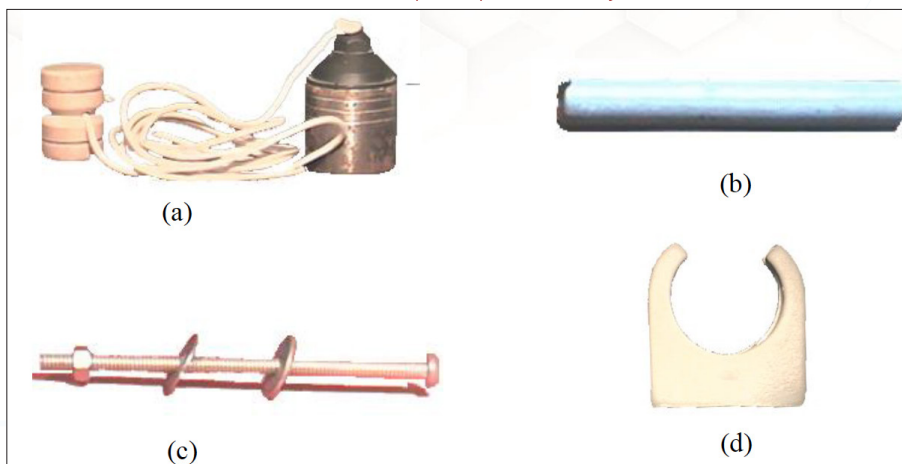
Figura 2 – Elemento sensível do pêndulo simples (a) prumo e outros materiais complementarem da montagem: (b) cano em alumínio; (c) parafuso com porca e duas arruelas e (d) suporte para instalação elétrica.
